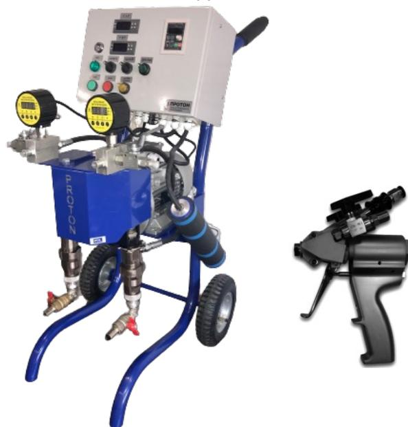
Аппарат высокого давления для напыления
